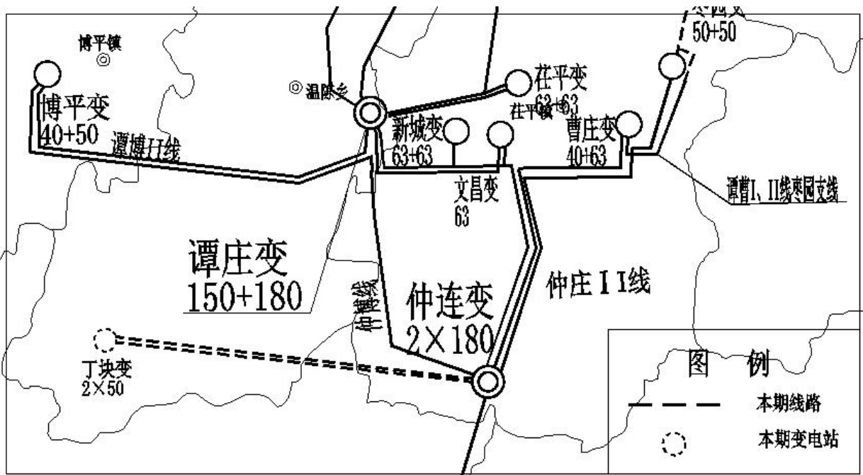
图 2 本工程电网改接后接线简图
