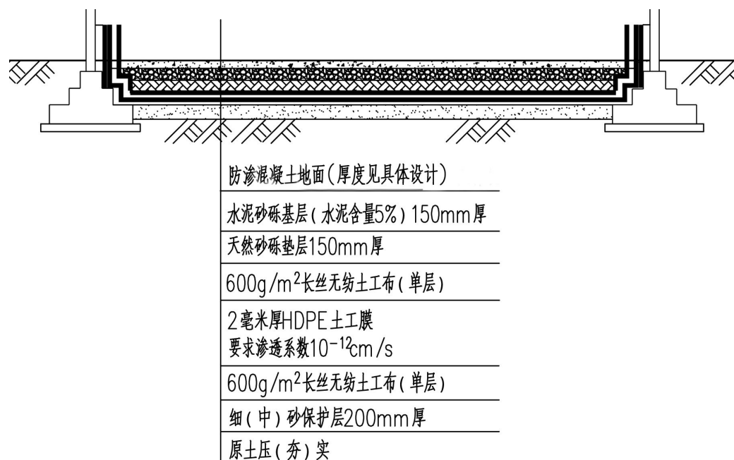
图 6.5-2 危险废物贮存区防渗结构图
