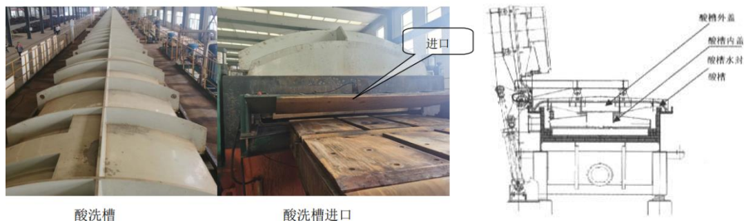
图 2.7-1 连续盐酸浅槽紊流酸洗装置图
